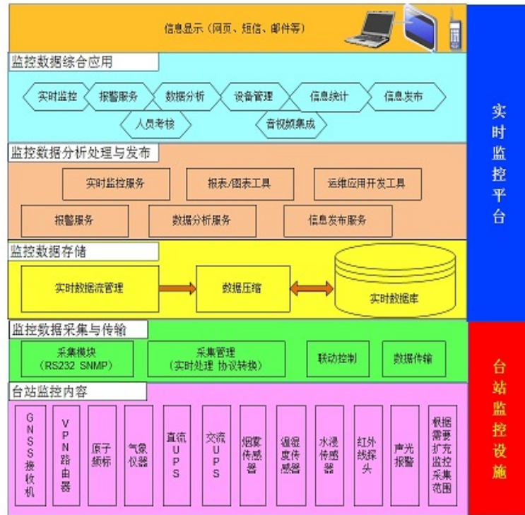
图 1 监控平台逻辑结构图
